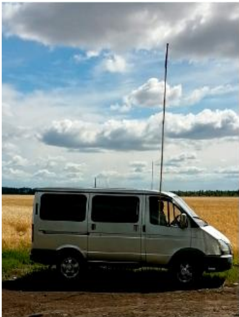
ПЕРЕДАЮЩАЯ СТОРОНА РАДИОЛИНИИ (высота подъема антенны 5 м)
